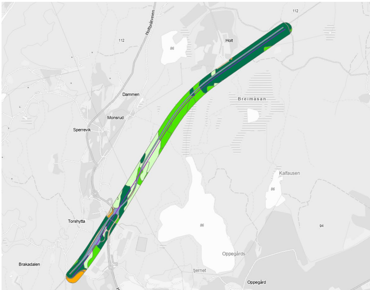
Figur 2: Illustrasjon av E134 Oslofjordforbindelsen, byggetrinn 2, med en trasébredde på 80 meter og med areal-typer klippet ut fra arealressurskartet AR5
