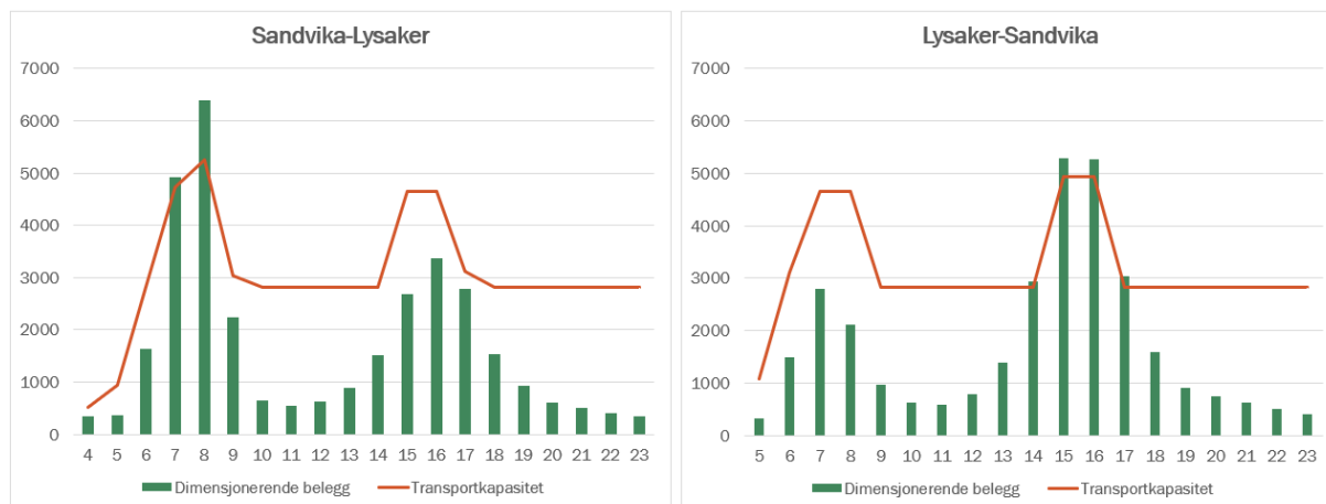
Figur 4-17. Transportkapasitet og utnyttelse langs fellesstrekningen Sandvika-Lysaker (gjennomsnitt for en time for alle avganger). Kilde: Norconsult (ved bruk av RTM23+, Trenklin og Kapmon)
