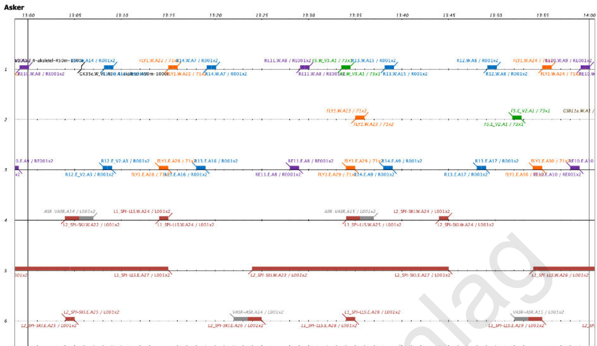
Figur 8: Sporbruk på ombygd Asker stasjon med fire vendende lokaltog i NTP25-36. Den grå delen av ankommende (spor 4) og avgående (spor 6) lokaltog viser kjøring til og fra vendesporet.
